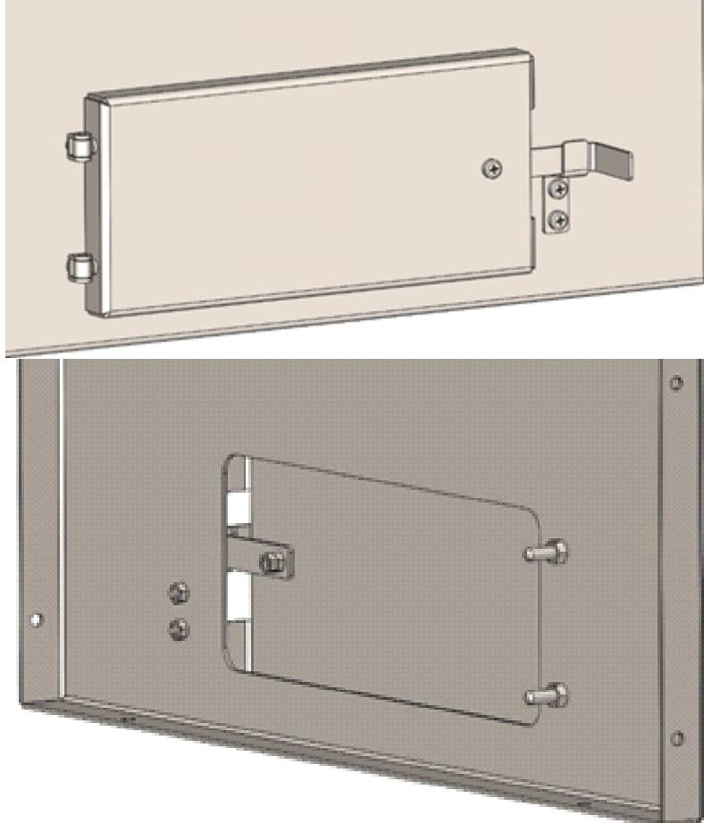
Установите вторую гайку M5 так, чтобы ручка двери была зафиксирована и стяните гайки между собой, обеспечив свободное перемещение ручки на винте.
