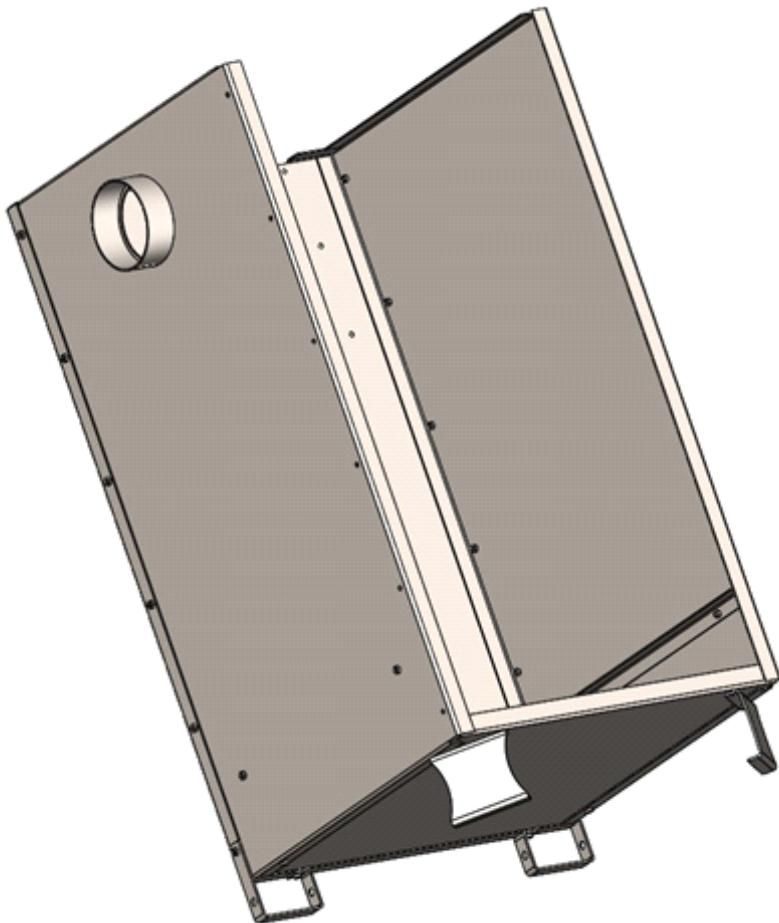
**Шаг 3:** Установите дверцу зольную (с помощью ввертных петель) с запирающим механизмом (петля и ручка двери) на стенку лицевую
