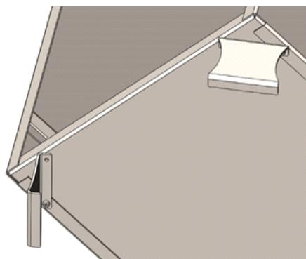
на данном этапе ножки закрепите на один винт, иначе возникнут сложности при установке стенки лицевой
